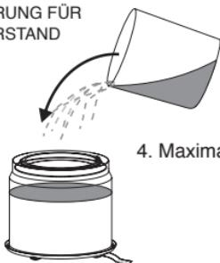
4. Maximal 80 ml Wasser befüllen
